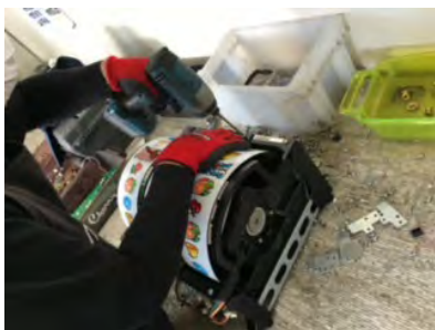
パチンコ・パチスロ解体作業
