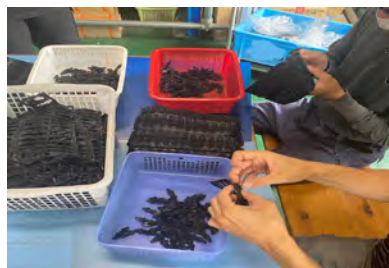
ゴム製品の型抜き作業です。
