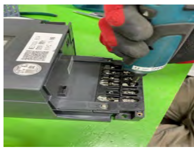
電気メーター解体作業
